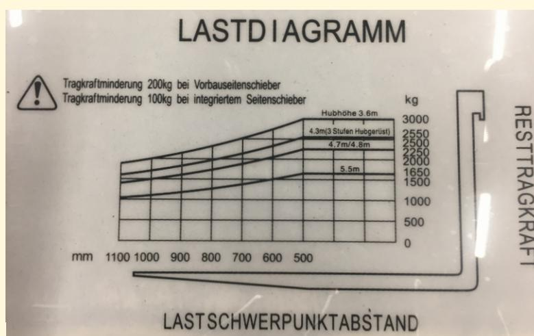
**ACHTUNG:** Tragkraft ist abhängig vom Lastschwerpunkt sowie der Hubhöhe
