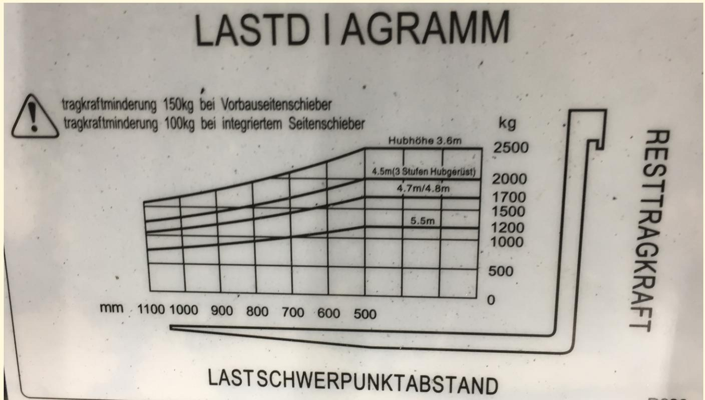
**ACHTUNG:** Tragkraft ist abhängig vom Lastschwerpunkt sowie der Hubhöhe
